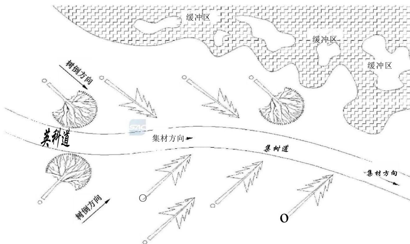
图2 伐区树木倒向示意图
